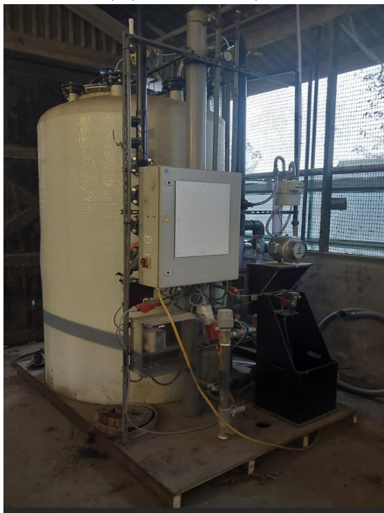
Figuur 2-1. Verplaatsbare vergister in de stal (links) plus een bezinker en opslagvat buiten de stal (rechts).
